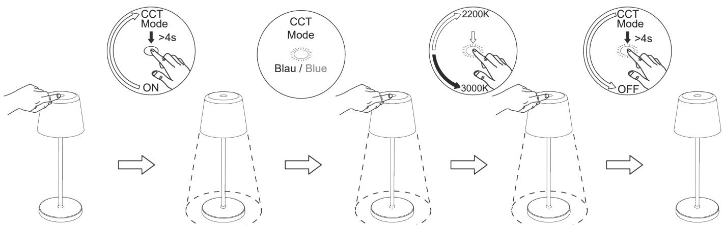
Wenn innerhalb von 10 Sekunden keine Bedienung erfolgt, verlässt die Leuchte automatisch den Farbtemperatur-Umschaltmodus.
