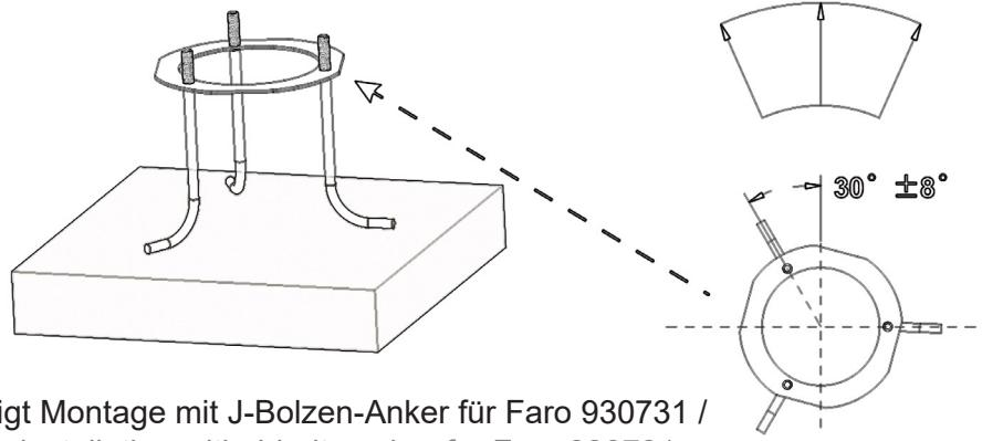
Abbildung zeigt Montage mit J-Bolzen-Anker für Faro 930731 /
