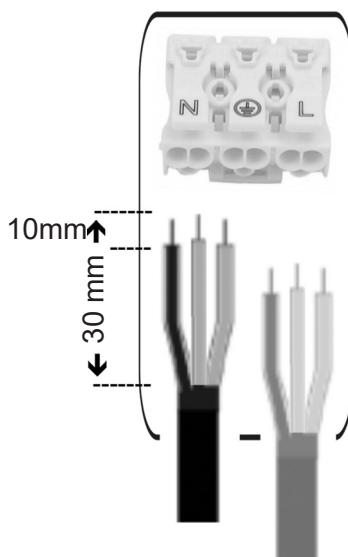
Die Anschlussbox bietet die Möglichkeit einer Durchgangsverdrahtung. Wenn Sie dies nutzen, verwenden Sie eine 3-polige Leitung um auch am Ende der Installationskette einen PE zur Verfügung zu haben.
