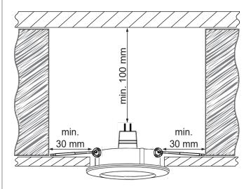
Zur Abdeckung mit Wärmedämm-Material nicht geeignet.
